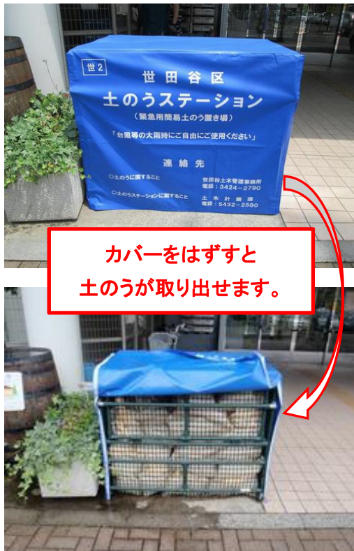
写真：城山分庁舎に設置してある土のうステーション
